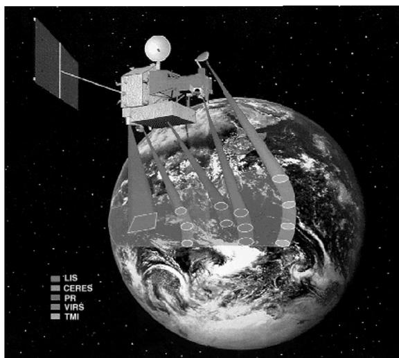
Satélite de TRMM que lleva el instrumento de CERES junto con cuatro otros instrumentos en la misión para medir pluviosidad tropical.
