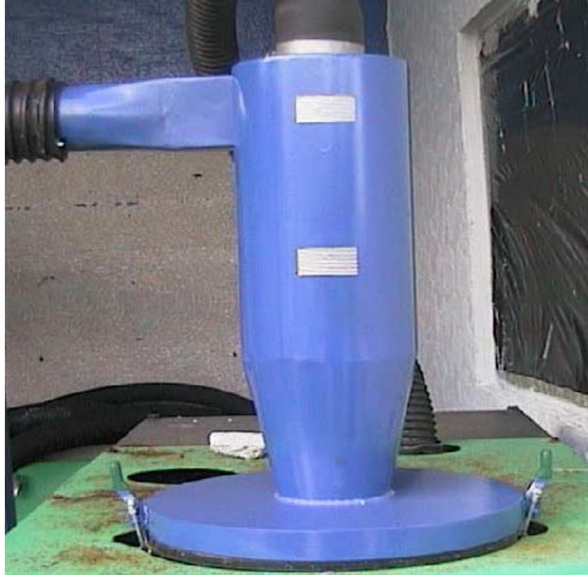
Fig. 11 New centrifugal separator.
