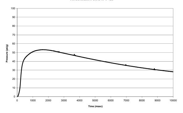
FIGURE 20. THE HFC-125 PRESSURE PULSE AT 8.9% (TEST 17)
