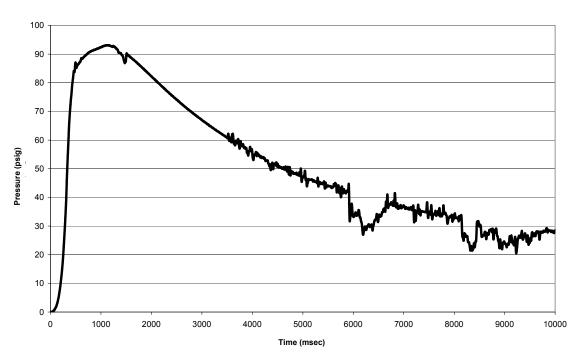
FIGURE 16. THE BTP PRESSURE PULSE AT 6.0% (TEST 13)
