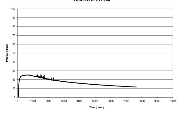
FIGURE 6. NO AGENT PRESSURE PULSE (TEST 3)
