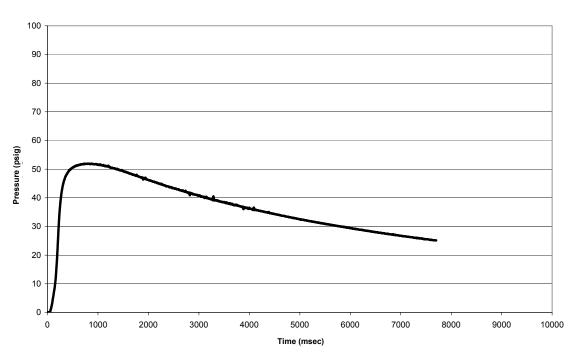
FIGURE 24. THE HFC-125 PRESSURE PULSE AT 6.2% (TEST 23)
