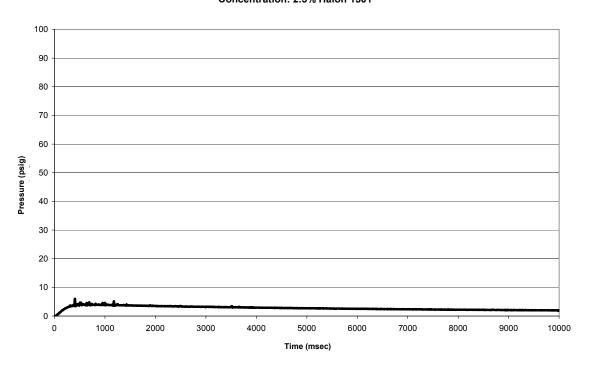
FIGURE 18. THE HALON 1301 PRESSURE PULSE AT 2.5% (TEST 16)
