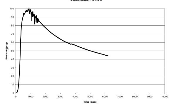
FIGURE 14. THE BTP PRESSURE PULSE AT 5.0% (TEST 9)
