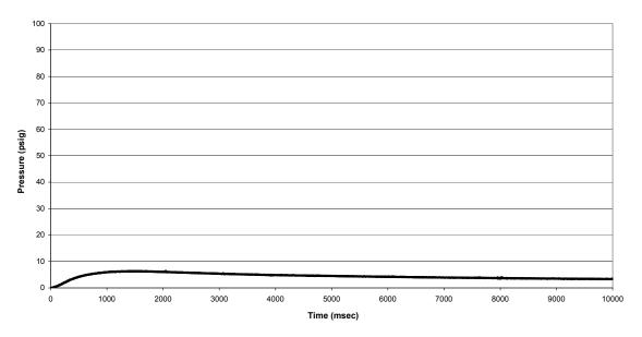
FIGURE 26. THE HFC-125 (P<sub>o</sub>=15 psig) PRESSURE PULSE AT 11.3% (TEST 25)
