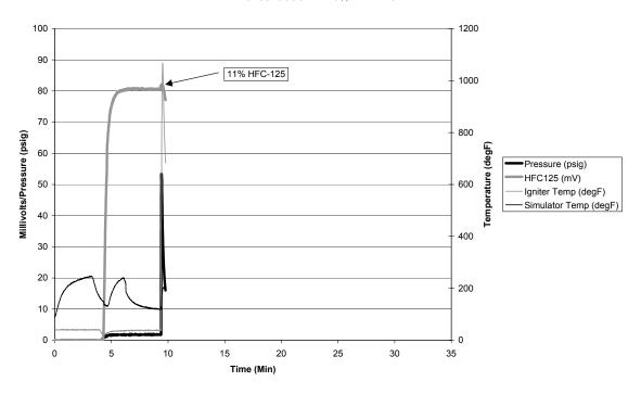
FIGURE 21. GAS AND TEMPERATURE TRACES FOR TEST 19
