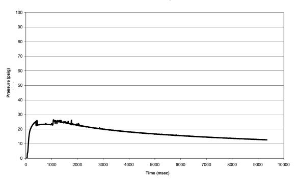
FIGURE 8. NO AGENT PRESSURE PULSE (TEST 4)
