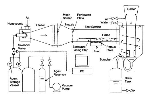
Fig. 1 Experimental apparatus.
