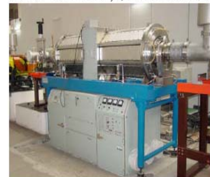
图3 主环高频累积腔系统已安装在线
