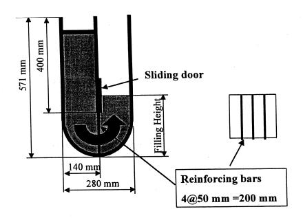
Figure 1. U-flow test<sup>5</sup>
