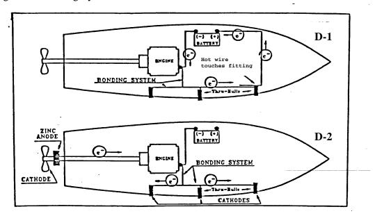
FIGURE D-1: TYPICAL BONDING SYSTEM
