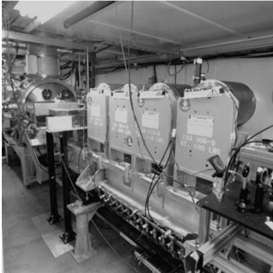
Figure 7.5: Photographie de la chicane magnétique (premier plan) et du cryostat de la cavité de capture (arrière plan).
