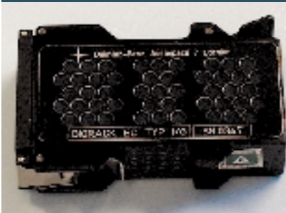
A vented EC-1, you can see the holes drilled and protected by a semipermeable membrane of Goretex™. L'EC-1 aéré percé d'orifices et protégé par une membrane semi-perméable de Goretex™.
