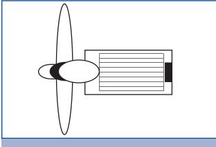
Figure 2-9. Propeller Fan
