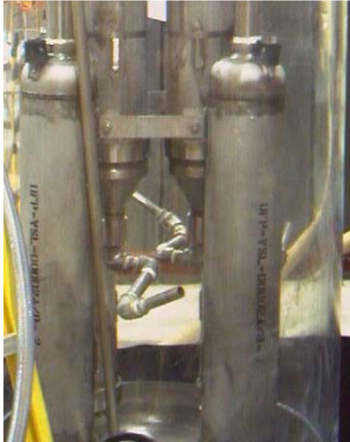
Figure 2.12. Actual Prototype Final UFP RH Discharge Nozzles
