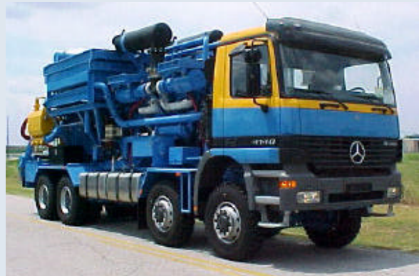
Fig. 18. Hot oiling truck
