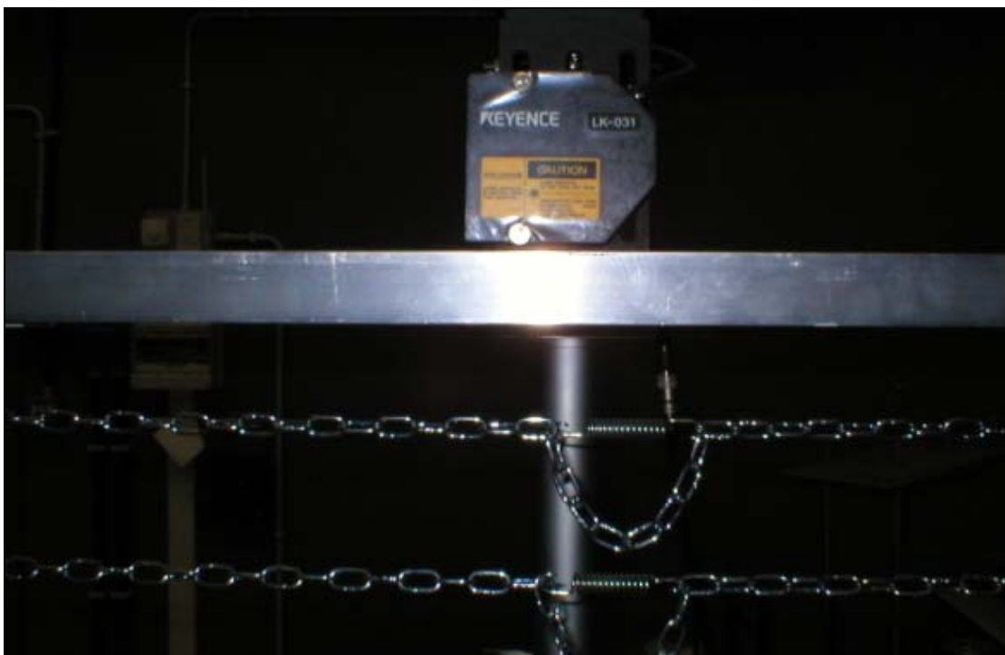
Figura 130: Immagine del comparatore laser impiegato per la misura della freccia del transetto durante la fase di testing del supporto realizzato in collaborazione con il centro ENEA di Frascati.
