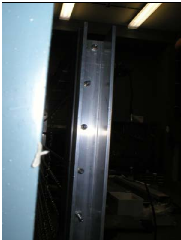
Figura 129: Supporto ENEA nella sezione in cui si sono avvitati i ganci per il tensionamento delle catene con collegate le molle di trazione.
