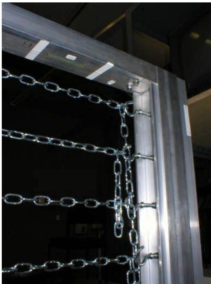
Figura 126: In alto a destra del particolare del supporto si noti il vincolo interno al prototipo, si noti anche la fibra ottica applicata in quella zona.
