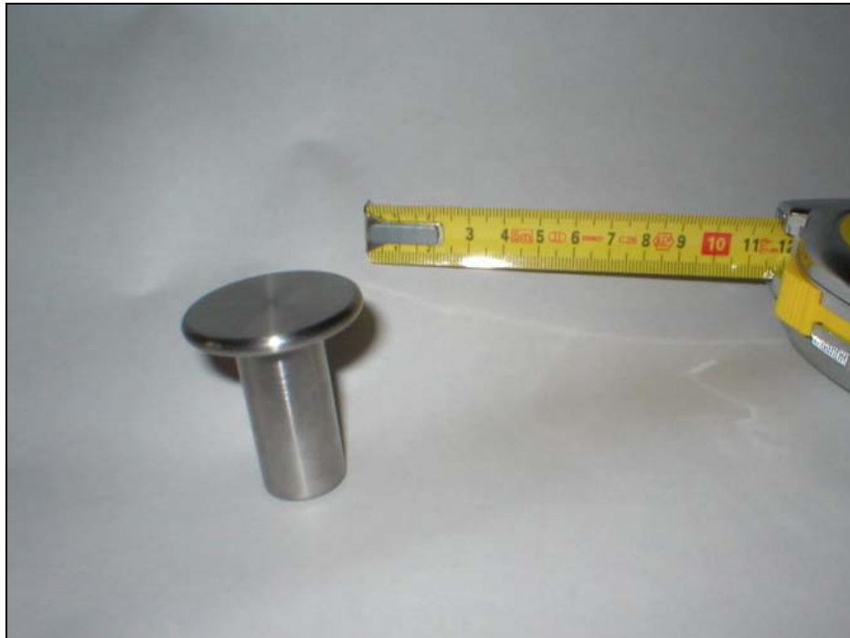
Figura 50: Fresa impiegata per la lavorazione del rohacell. E' realizzata in acciaio rettificato.
