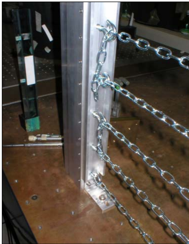
Figura 125: Foto della staffa che fissa al banco di taratura il prototipo del frame.
