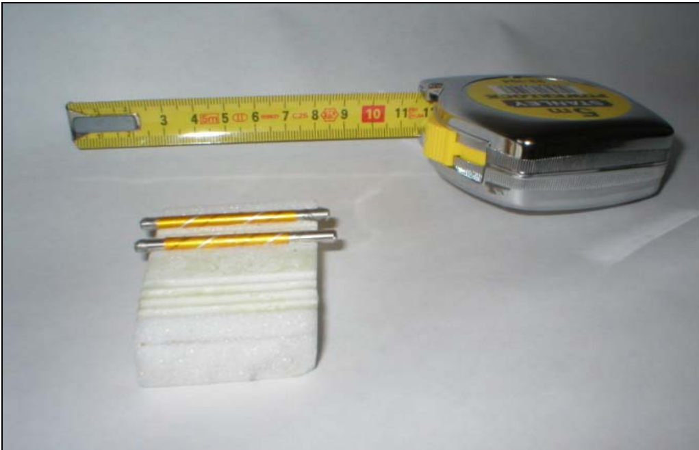
Figura 61: Altra immagine del campione di rohacell con i due straws incollati.
