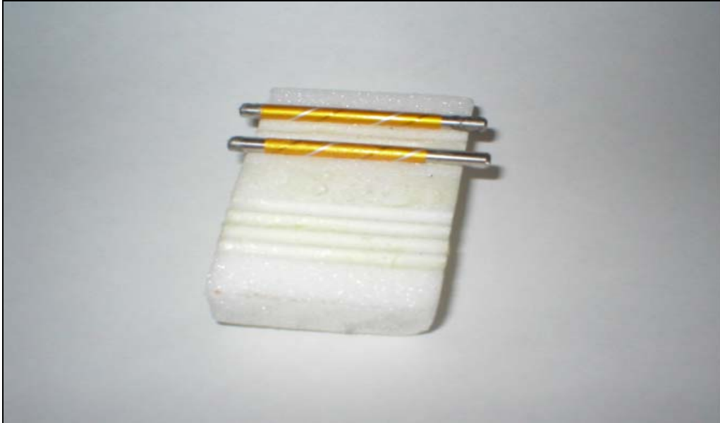
Figura 60: Immagine ravvicinata di un campione di rohacell 31 IG con due straws incollati negli solchi eseguiti, la verifica della circolarità dei sensori ha dato risultati positivi.
