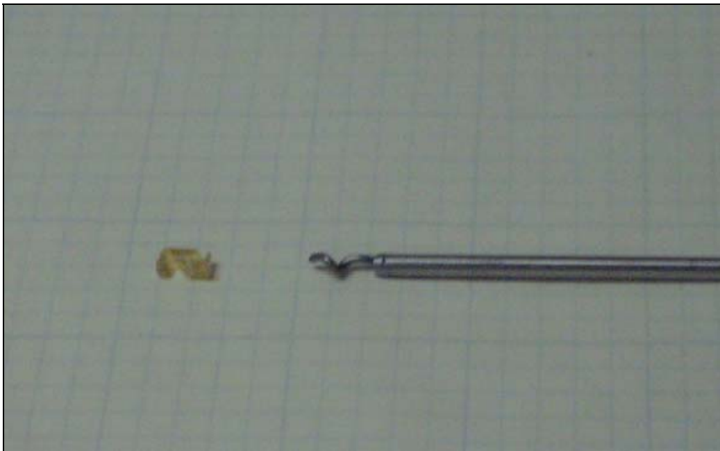
Figura 31: Twister con spirulina a resistenza per il riscaldamento del twister all'interno dello straw.
