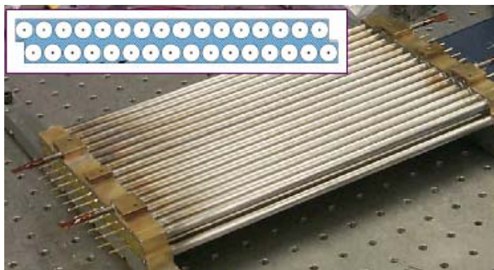
Figura 12: Tubi proporzionali pronti per il montaggio nel sistema muonico, in alto la loro disposizione su un piano trasversale alle basi.
