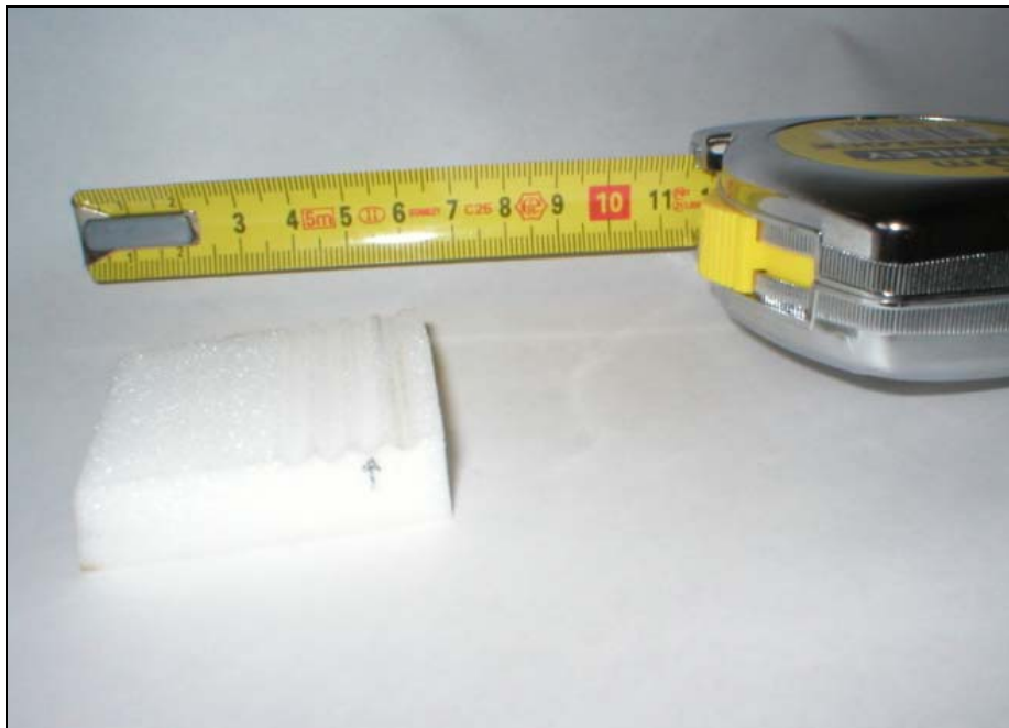
Figura 49: Stesso campione di rohacell fotografato da un'altra angolazione, si noti lo solco a destra bruciato. Gli altri 3 sono venuti meglio in quanto si è ridotta la velocità di rotazione della fresa.
