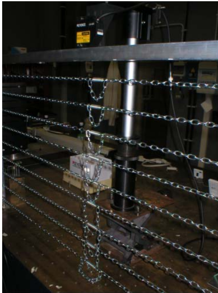
Figura 128: Prototipo del supporto con carico di trazione generato da 9 catene tensionate da altrettante molle di trazione, il dispositivo che si vede in figura è un comparatore laser in grado di valutare lo spostamento verticale del transetto.
