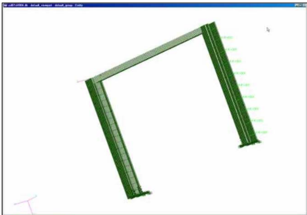
Figura 137: Riproduzione al FEM con elementi tridimensionali del supporto ENEA completo di vincoli e carichi.
