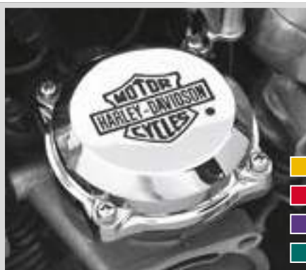
J. CV-VERGASERDECKEL – BAR & SHIELD
