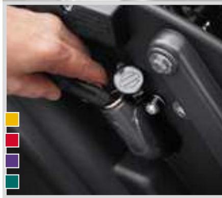
D. ZUSÄTZLICHER STROMANSCHLUSS – SATTELASCHENMONTAGE
