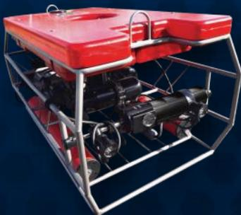
El Diavolo III es la evolución del FO III con un motor adicional que mejora el desplazamiento lateral del ROV.
