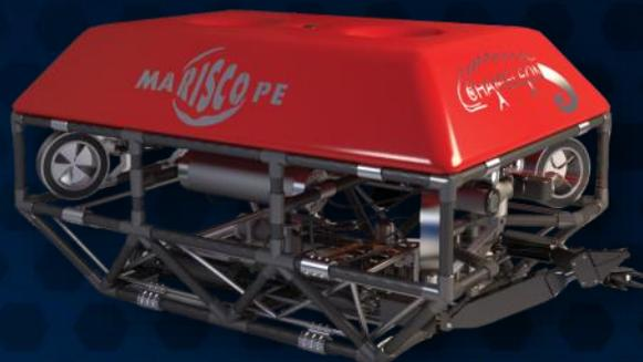
Sus propulsores vectorizados con 600 o 900 W de potencia cada uno, otorgan una capacidad de propulsión de 15-30 Kg en cada motor.
