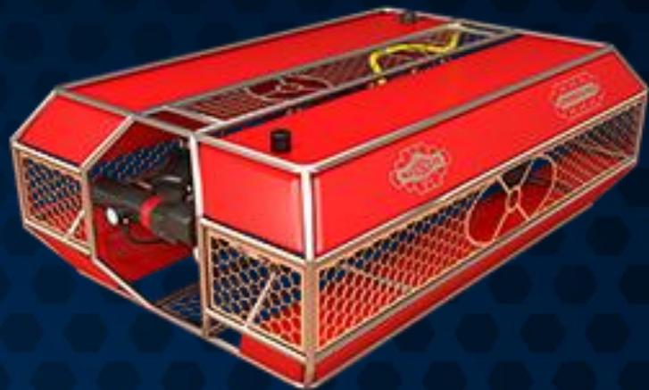
La versión estándar posee motores 6 motores brushless de acople magnético con una potencia de 600 W cada uno en disposición vectorizada, lo que le permite alcanzar una velocidad de 3/5 nudos manteniendo una excelente maniobrabilidad.
