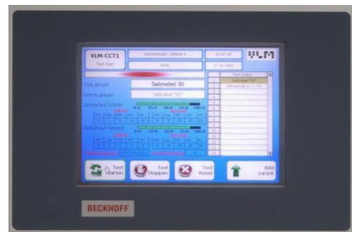
ClimaCORR® Steuerung (SPS) mit 6,3" Farbdisplay
