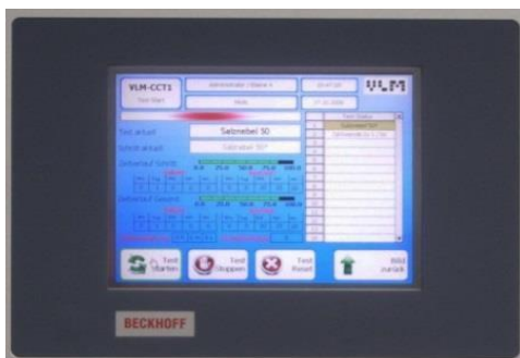
ClimaCORR® Steuerung (SPS) mit 5,7" Farbdisplay
