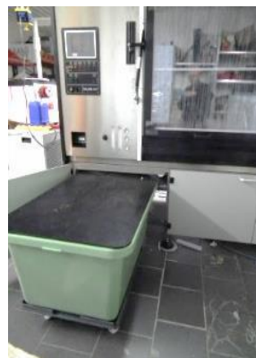
300 L Testlösungstank auf Rollen mit Füllstandsensoren, leicht zu reinigen, direkter Zugang, z.B. zur Messung und Einstellung des pH- Wertes
