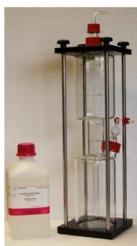
DosiCORR® MD Apparatur zur Dosierung von SO 2
