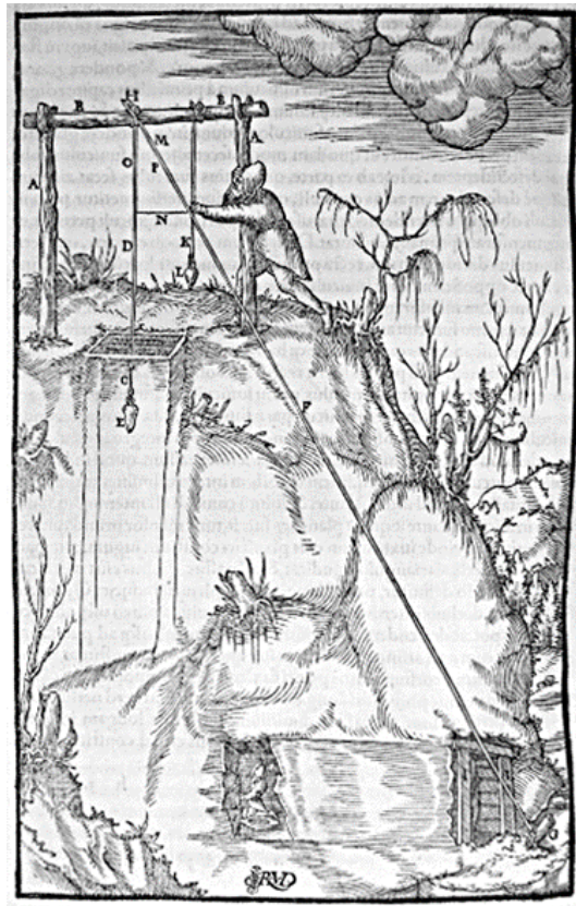
Figure 1 : Mesurage d'une mine selon Georgius Agricola, dans le cinquième livre du De Re Metallica (1556). Le géomètre cherche à déterminer la distance restant à creuser avant que le puits de mine rencontre la galerie correspondante. Il attache deux cordes et un fil à plomb au treuil, construisant un petit triangle rectangle semblable au grand triangle formé par le puits et la galerie.
