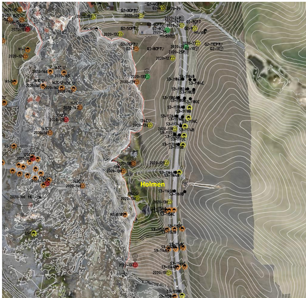
Figur 3-1: Terrenget etter skred med oversikt over utførte grunnundersøkelser. Grønn farge angir borer hvor det ikke er sprøbruddmateriale (bekreftet med prøver), gul farge angir borer hvor det ikke er klare indikasjoner på sprøbruddmateriale (ikke bekreftet med prøver), oransje punkter angir borer med indikasjoner på sprøbruddmateriale (ikke bekreftet med prøver) og røde punkter angir borer hvor det er påvist sprøbruddmateriale på opptatte prøver. Fargene sier ikke noe om mektigheten på eventuelt lag med sprøbruddmateriale, eller hvilken dybde dette befinner seg i. Omriss av skredområdet er markert med rødstiplet linje.
