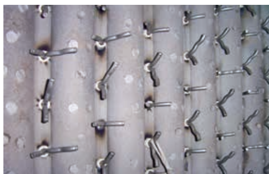
Verschiedene Geometrien und Ankertypen sowie ein breites Spektrum von Werkstoffkombinationen sind schweißbar
