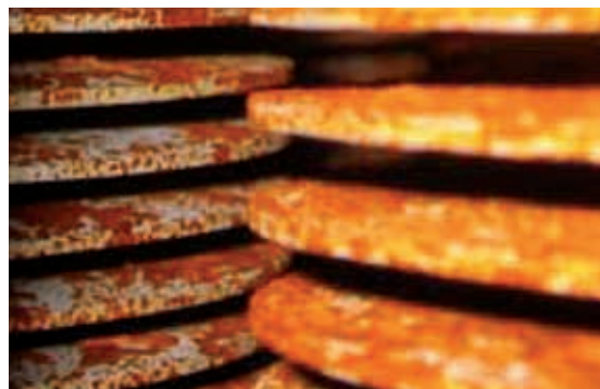
Mit der nasschemischen Reinigung werden Anhaftungen auch in schmalen Zwischenräumen entfernt
