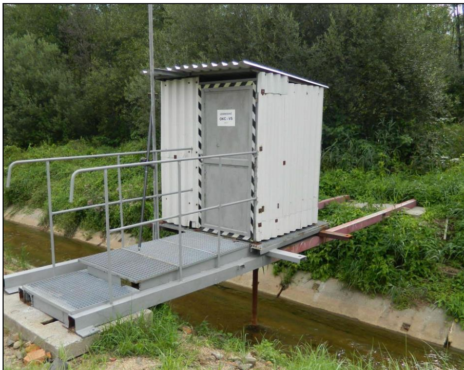
Obrázek č. 1-3: OKC-VS – monitorovací místo kvality důlních vod před zaústěním obtokového kanálu do Ploučnice
