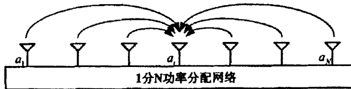
图3.9 N元振子阵列天线示意图
