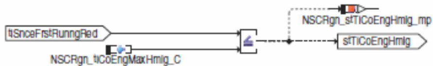
Abb. 6: Die stTiCoEngHmlg-Signallogik, die zum Setzen des Befehls stDNOxHmlg erforderlich ist, damit die Regeneration im Rahmen des „Homologations“-Programms eingeleitet werden kann. In dem von uns untersuchten Firmware-Image 55265162 des Fiat 500X ist NSCRgn_tiCoEngMaxHmlg_C auf 1600 Sekunden festgelegt. Copyright der Robert Bosch GmbH.
