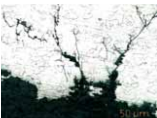
Beispiel für transkristalline Spannungsrisskorrosion an 1.4401 bei starker Chloridbelastung
