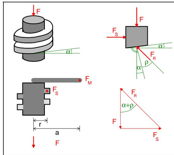
Bild 7.9: Kräfte an der Schraube mit Reibung
