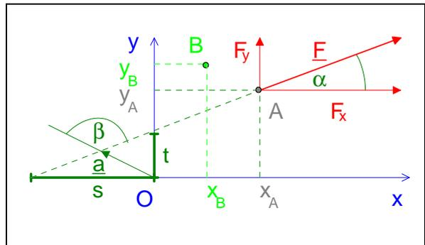
**Bild 1.14: Drehmoment einer Kraft**
