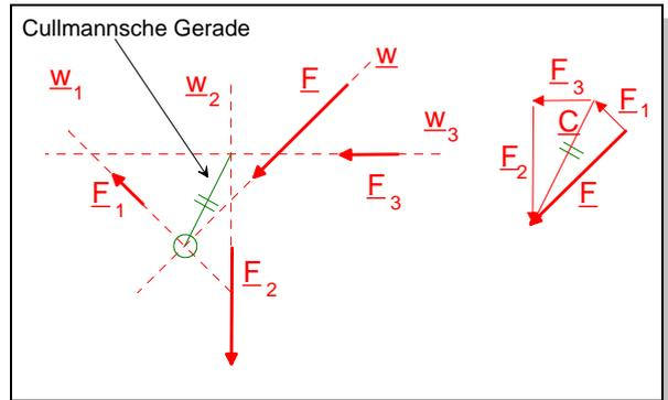
**Bild 1.27: Zerlegung einer Kraft in drei nicht zentrale Richtungen**
