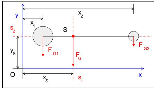
**Bild 3.2: Schwerpunkt von ebenen Punktmassen**
