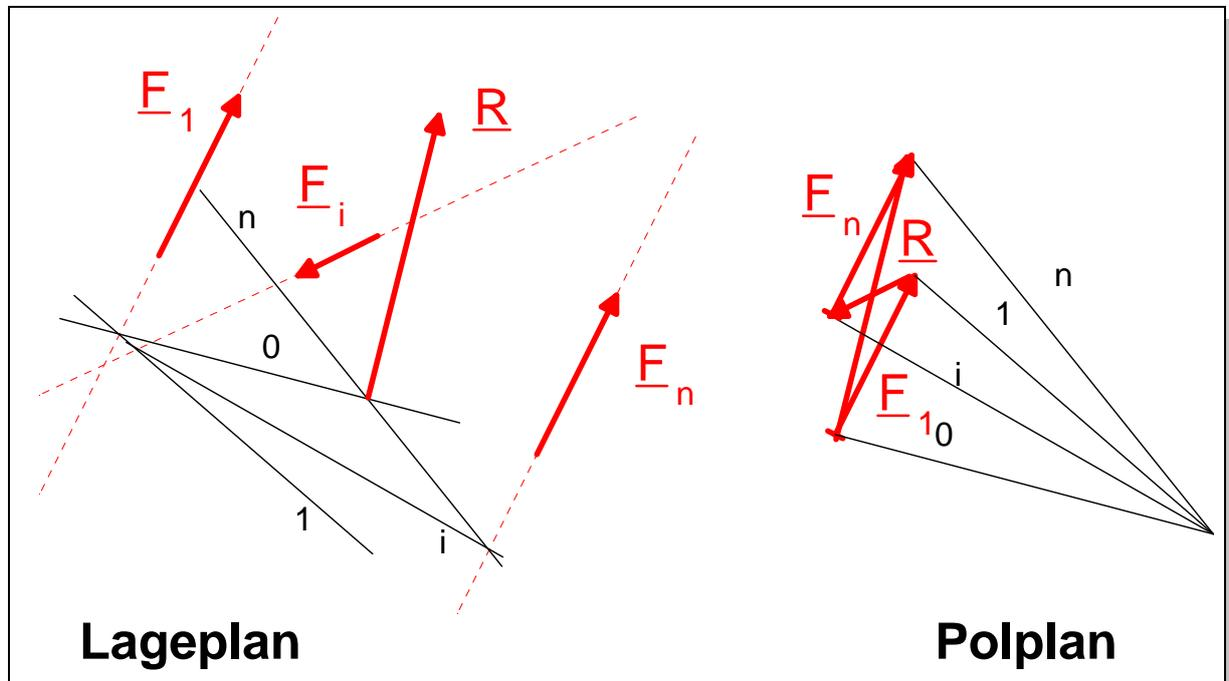
**Bild 1.22: Zeichnerische Lösung des allgemeinen Kräftesystems mittels Seileckverfahren**
