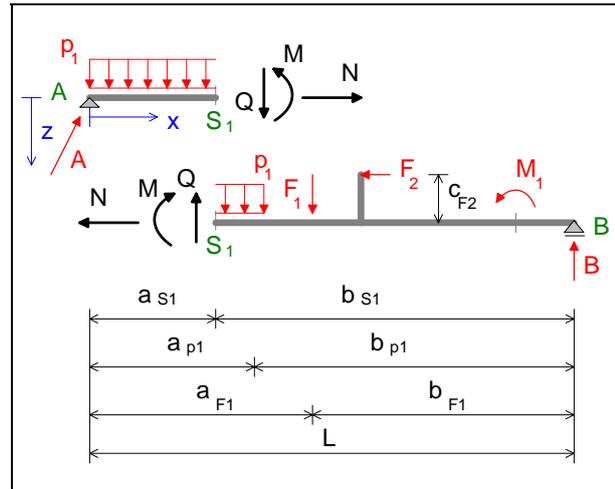
**Bild 4.5: Schnitt am Punkt  $S_1$**
