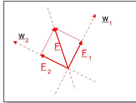
**Bild 1.27: Kraftzerlegung in zwei Richtungen**
