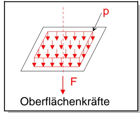
**Bild 1.3: Oberflächenkräfte**
