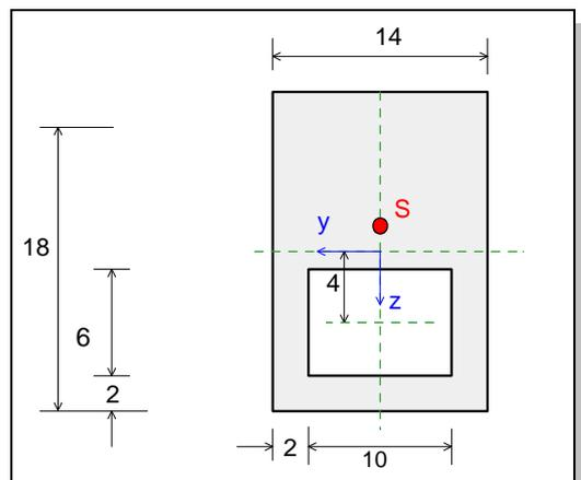
**Bild 3.11: Rechteckquerschnitt mit rechteckiger Aussparung**
