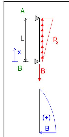
Linear veränderliche Linienlasten, wie sie bei prismatischen Stäben von Fliehkräften hervorgerufen werden, haben einen parabolischen Verlauf der Normalkraft zufolge. Dort, wo die Belastung verschwindet, hat die Normalkraft eine zur x-Achse parallele Tangente. Dort, wo die Belastung am größten ist, wird die Tangente der Normalkraftlinie am steilsten.
