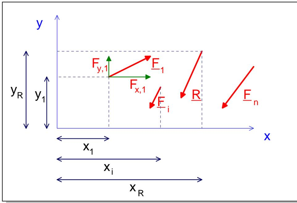
Bild 1.21: Rechnerische Lösung der Ersatzkraft im allgemeinen Kräftesystem
