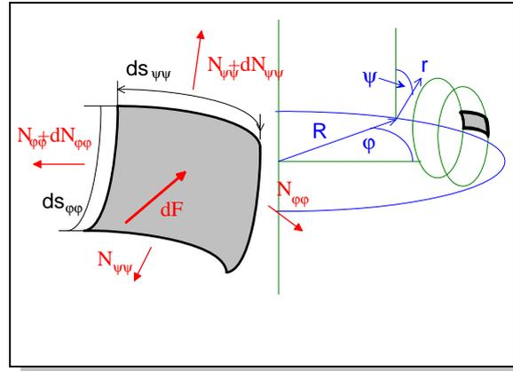
Bild 6.2: Bezeichnungen der angreifenden Kräfte
