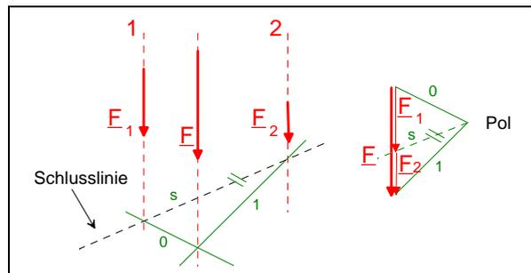
**Bild 1.26: Zerlegung einer Resultierenden in zwei parallele Kräfte**
