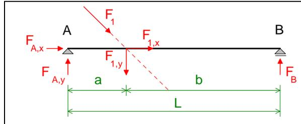
**Bild 2.9: Lösung der Auflagerkräfte am Einfeldbalken**
