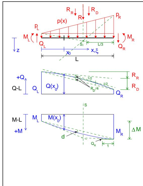
Bild 4. Balkenabschnitt mit linear steigender Last
