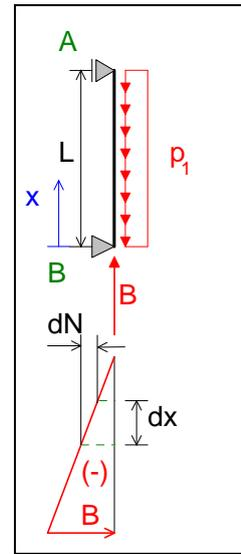
Prismatisch heißt ein Stab, wenn sein Querschnitt sich nicht verändert. Gleichlasten, also konstante Linienlasten, verursachen linear veränderliche Normalkraftverläufe. Bei großen Gleichlasten erhält man eine steile Normalkraftlinie.
