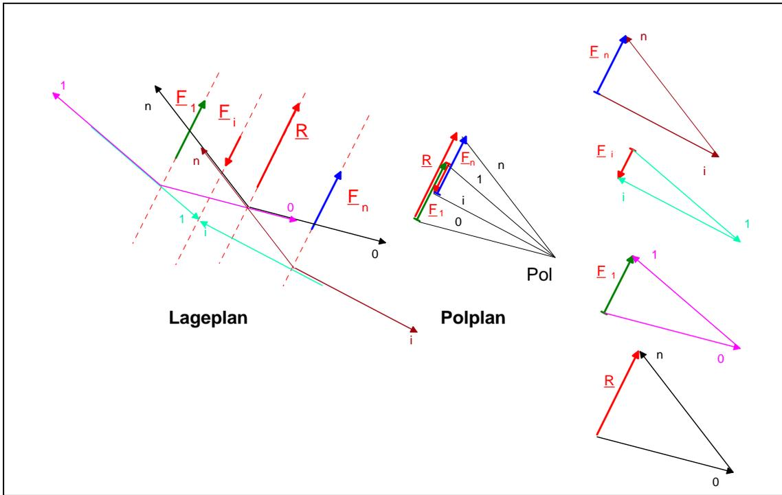
**Bild 1.22: Ersatzkräfte im Seileckverfahren**
