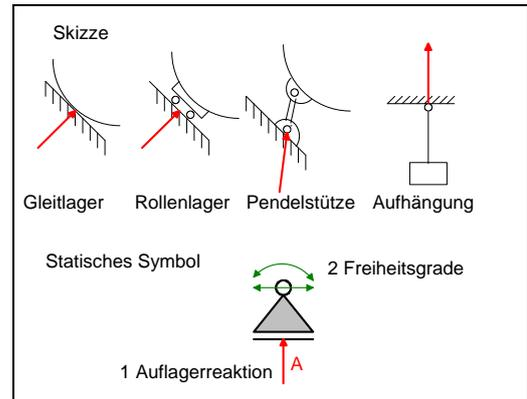
**Bild 2.3: Verschiebliches Kipplager**
