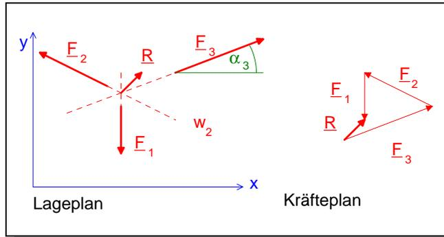
**Bild 1.16: Resultierende eines zentralen Kräftesystems**
