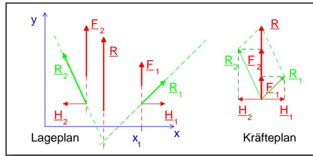
**Bild 1.17: Resultierende zweier paralleler Kräfte**
