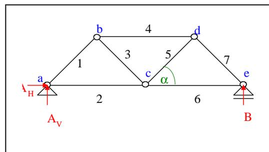
**Bild 5.2: Statisches System eines Fachwerks**
