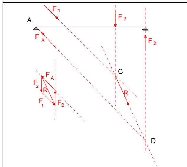
**Bild 2.10: Zeichnerische Lösung der Auflagerkräfte am Einfeldbalken**
