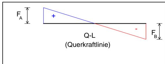
**Bild 4.13: Querkraftlinie**
