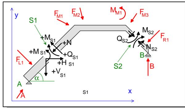
**Bild 4.2: Definition der Schnittkräfte an Stabtragwerken**
