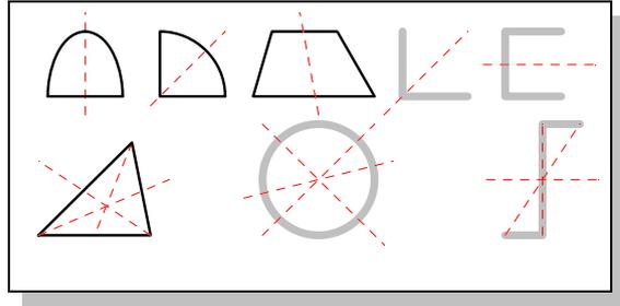
**Bild 3.10: Schwerlinien symmetrischer Querschnitte**
