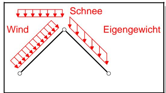
**Bild 1.4: Oberflächenkräfte**
