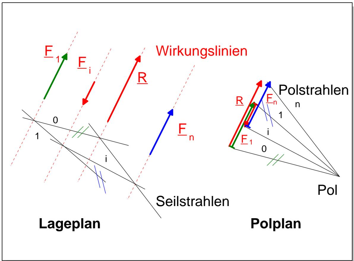
**Bild 1.21: Seileckverfahren im parallelen Kraftsystem**
