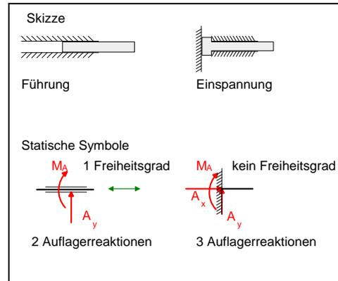
**Bild 2.5: Führungen und Einspannungen**
