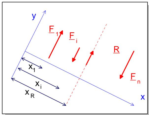
**Bild 1.20: Resultierende eines allgemeinen Parallelkraftsystems**
