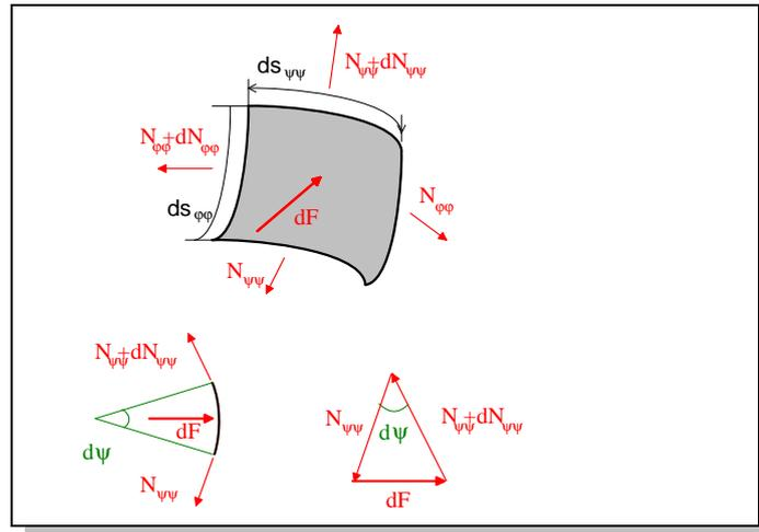
Bild 6.3: Gleichgewicht am Schalelement in Normalenrichtung
