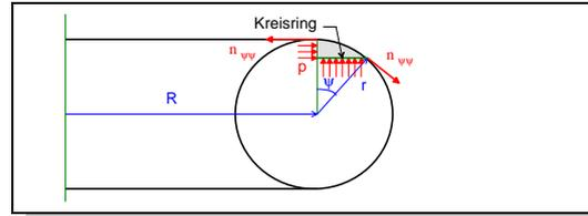
**Bild 6.4: Gleichgewicht an der Torusschale**
