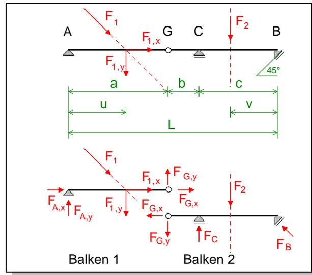
**Bild 2.11: Rechnerische Lösung der Auflagerkräfte am Zweifeldbalken**
