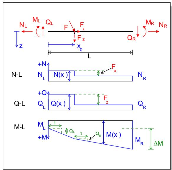
**Bild 4.17: Balkenabschnitt mit Einzellast**
