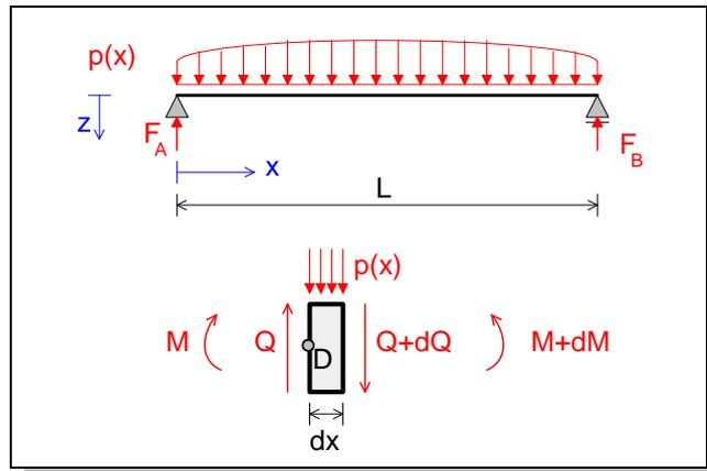
**Bild 4.11: Gleichgewicht am Balkenelement**
