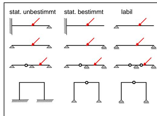
**Bild 2.6: Statische Bestimmtheit von Tragwerken**
