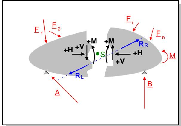
**Bild 4.1:** Definition der Schnittkräfte
