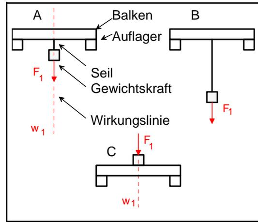
**Bild 1.10: Wirkungslinie einer Kraft**
