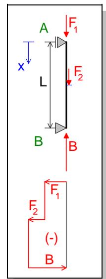
**Bild 4.8: Normalkraftverlauf verursacht durch Einzellasten**
