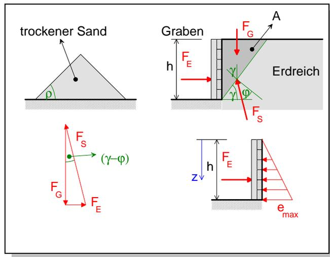
**Bild 7.12: Kräfte bei der Reibung in Schüttgütern**
