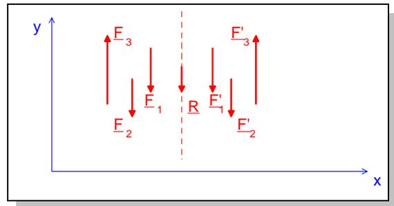
**Bild 1.19: Resultierende eines symmetrischen parallelen Kräftesystems**
