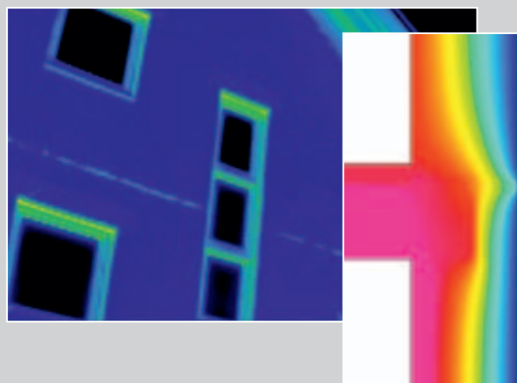
Abb. 6: Wärmebrücke am Beispiel einer Mörtelausgleichsschicht
