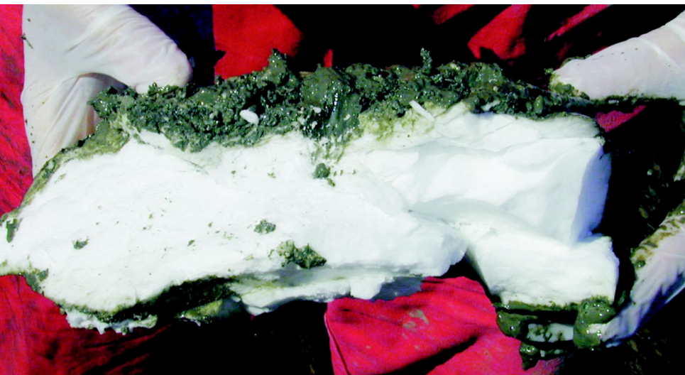
Abb. 9: Frische Bruchfläche einer etwa 10 cm dicken Gashydratlage unmittelbar nach der Bergung vom Meeresboden.
