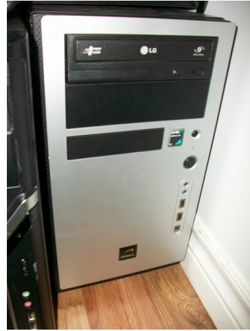
Ordi monté qui m'a été donné. Processeur AMD Athlon XP 2200+ 1.8 GHz dual- core. 2 GB RAM.
