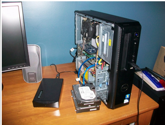
Dell Vostro 230. Pentium Dual-Core 3.06GHz. 4GB RAM. Nvidia 210 512MB ou Intel GMA 3500
