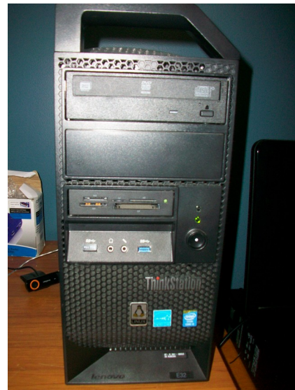
Tour à serveur. Processeur i3 (2 coeurs physiques et 2 logiques). 8GB RAM. Nvidia GT 610.
