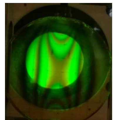
Figure 5: des lignes isochromatiques avec filtre
